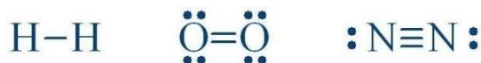
Figura 7. Representación de un enlace simple (H 2 ), enlace doble (O 2 ) y enlace triple (N 2 ).
